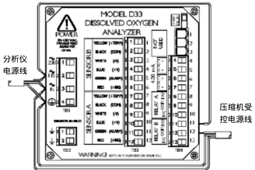
图 2-10 D33 分析仪与空气压缩机的接线
